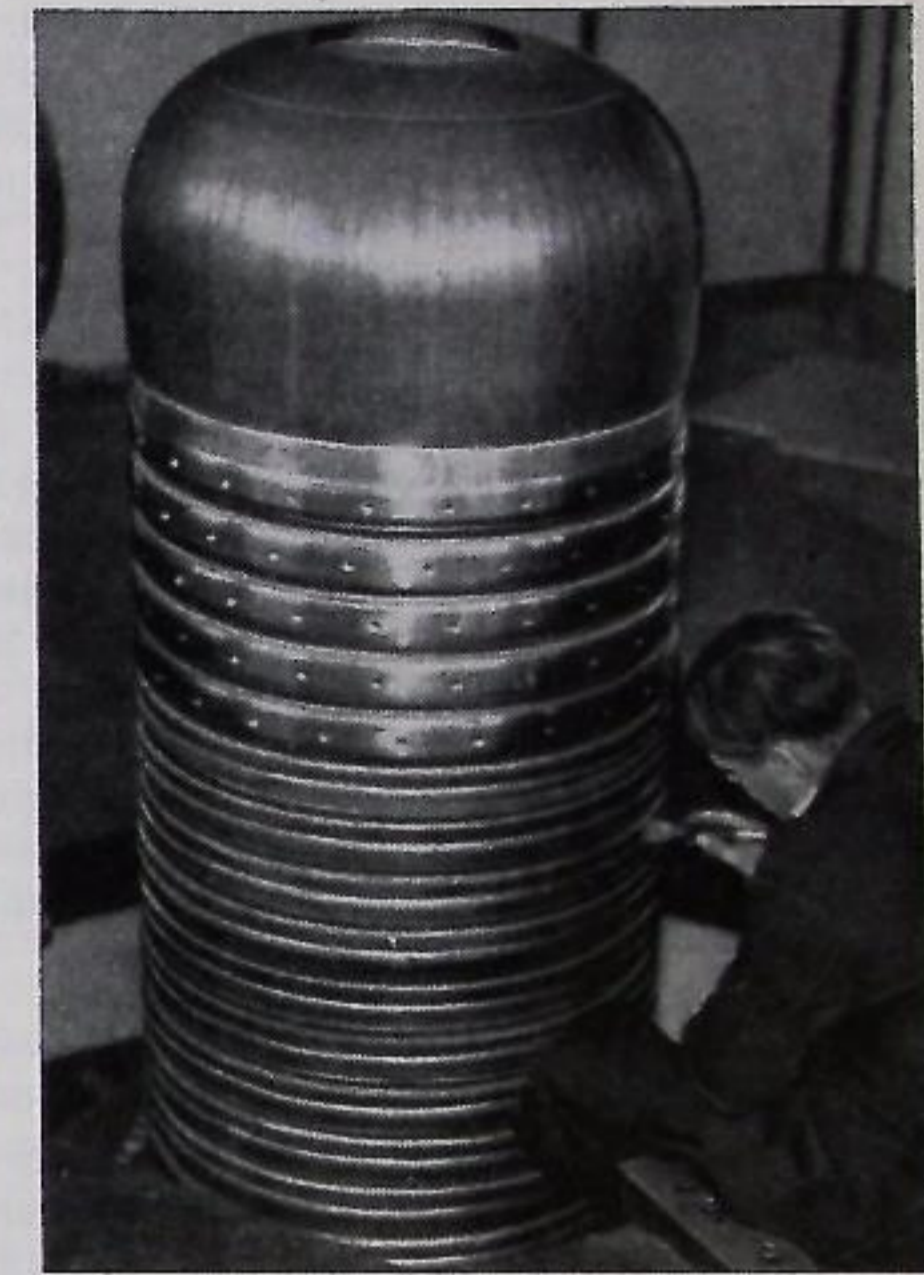
Рис. 5. Центральная колонна трансформатора.
