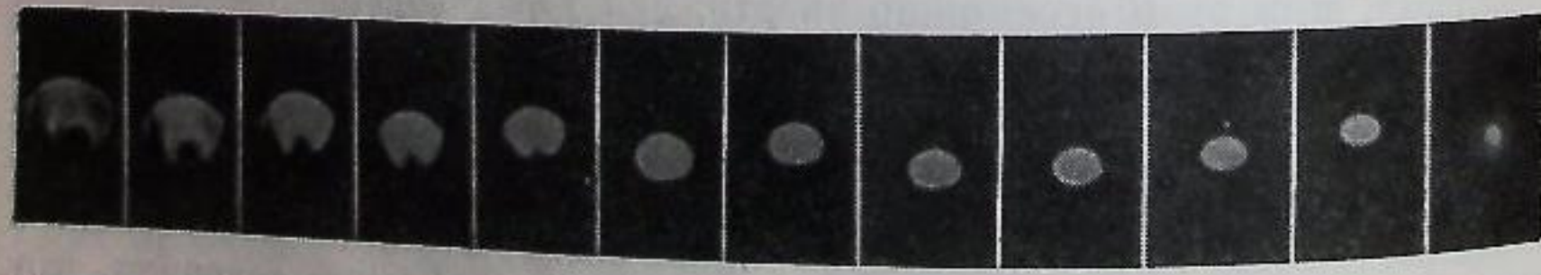
Рис. 7. Процесс затухания поперечных колебаний пучка электронов в накопителе после инжекции.
