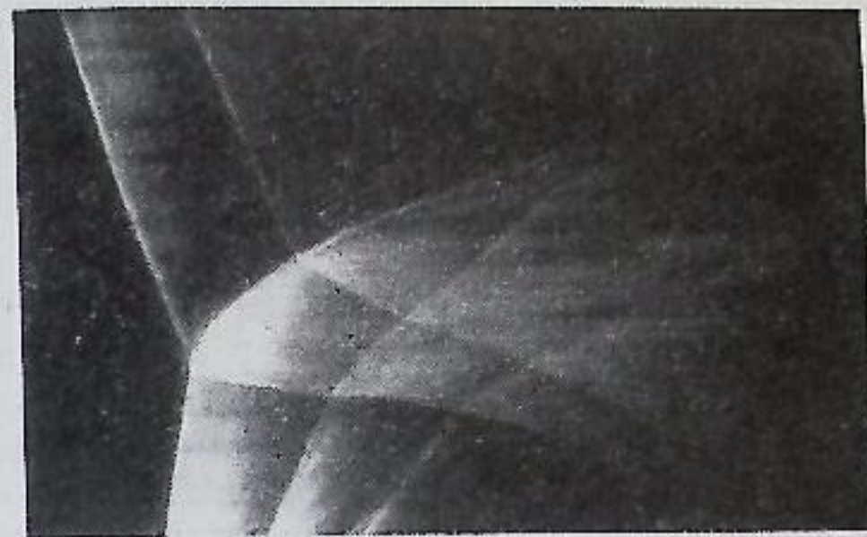
Рис. 4.10. Развертка свечения процесса столкновения двух ударных волн в воздухе, p_1 = 0,02 мм рт. ст.
