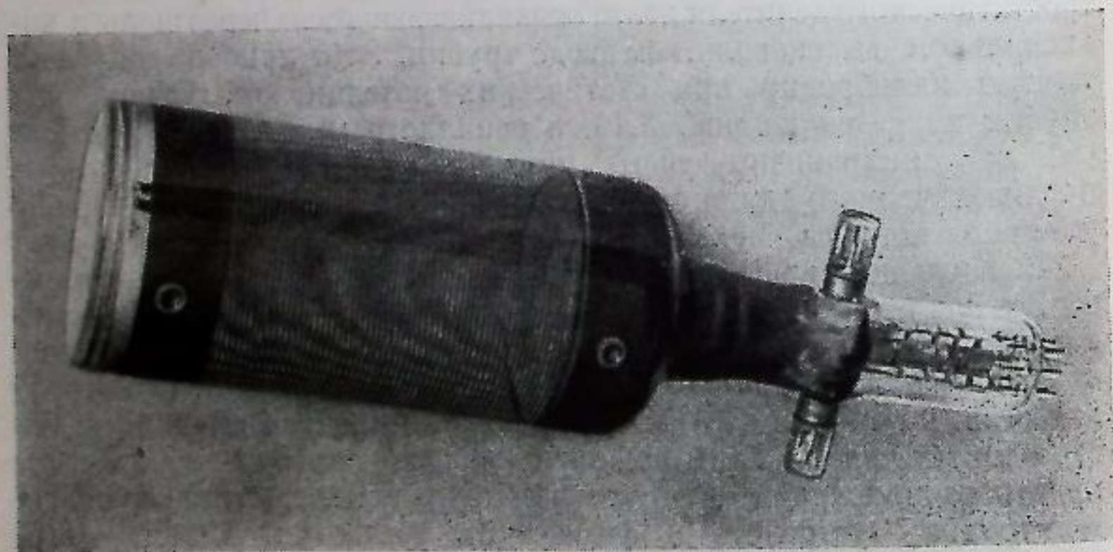
Рис. 3.10. Трубка для широкополосной регистрации высоковольтных импульсов
