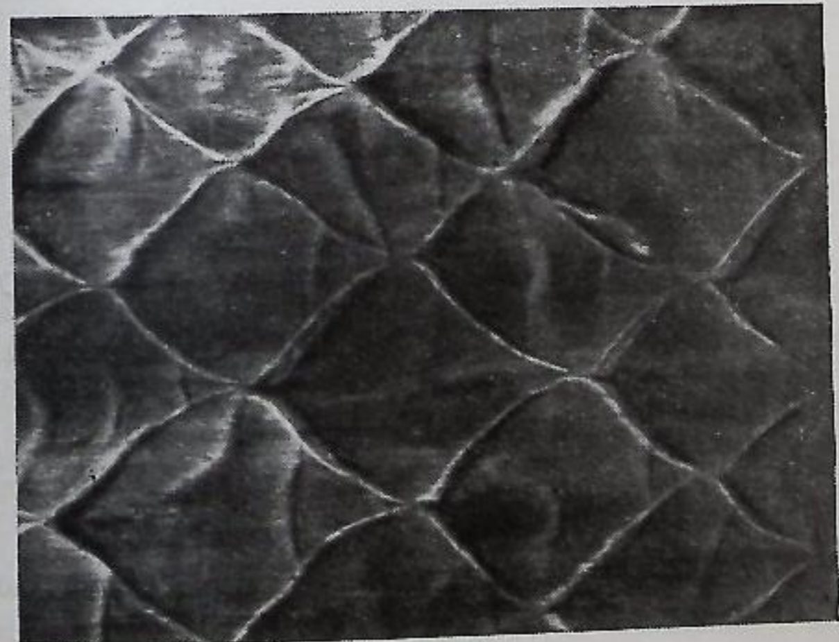
Рис. 4.12. Следовой отпечаток многофронтной структуры (а) и схема его расшифровки (б), по В.В. Митрофанову, детонация в смеси углерода с кислородом
