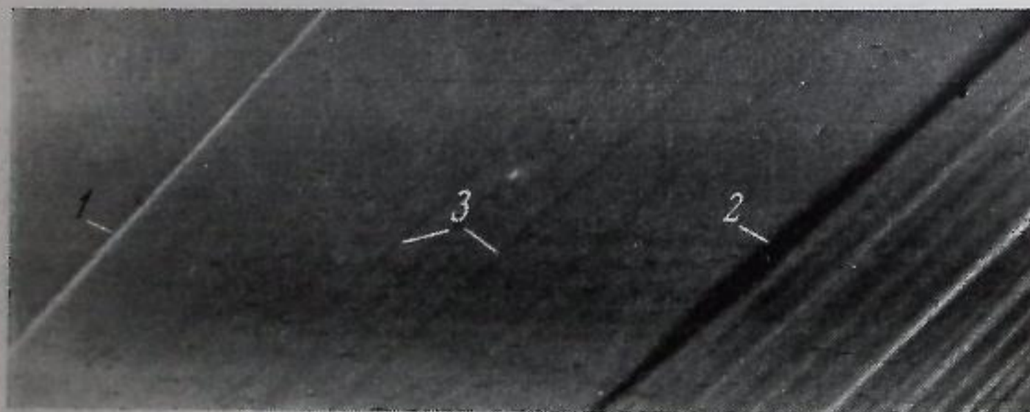
Рис. 4.9. Шлирен-снимок течения в ударной трубке: воздух, M_1 \sim 3,5 1 — фронт волны; 2 — контактная поверхность; 3 — следы, оптическая неоднородность
