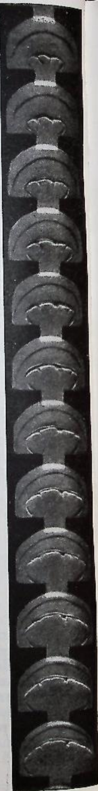
Рис. 4.20. Многокадровый снимок дифракции комп-лекса ударной волна — фронт горения (шлирен-снимок СФР)
