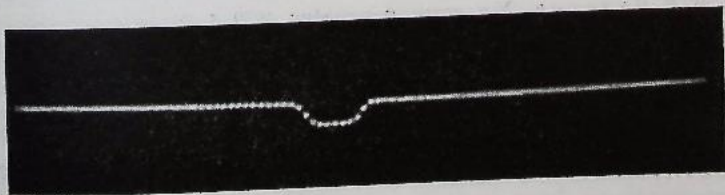
Рис. 5.13. Осциллограмма прямоугольного импульса на выходе электронного умножителя.
