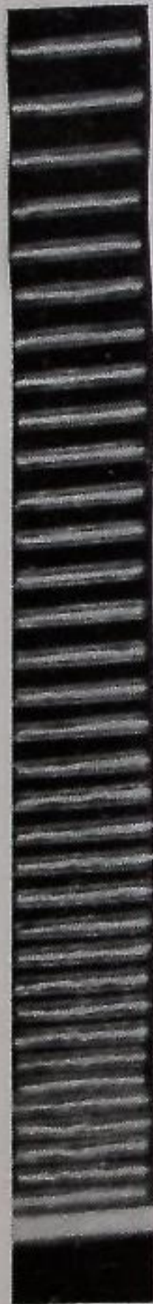
Рис. 4.18. Серия разрядов в искровом промежутке водородной импульсной лампы (RC-генератор, съемка фоторегистром)
