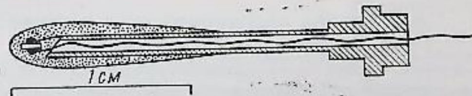
Рис. 9.2. Пьезодатчик из турмалина для измерения давления ударных волн в воде
