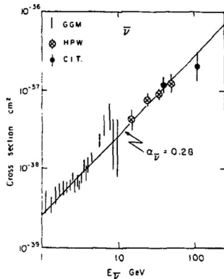
Рис.8. Инклюзивное сечение  $\bar{\nu} + N \rightarrow M^+ + \text{адроны}$  как функция энергии /10, 11/.
