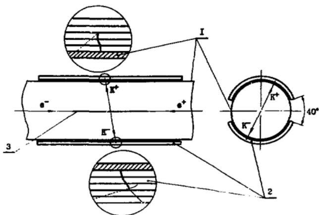
Рис.1. Принципиальная схема эксперимента: 1—стенка вакуумной камеры, 2—эмульсионные слои, 3—область взаимодействия пучков.
