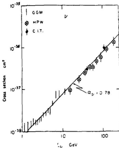
Рис.7. Инклюзивное сечение  $\nu + N \rightarrow M^- + \text{адроны}$  как функция энергии /10, 11/.
