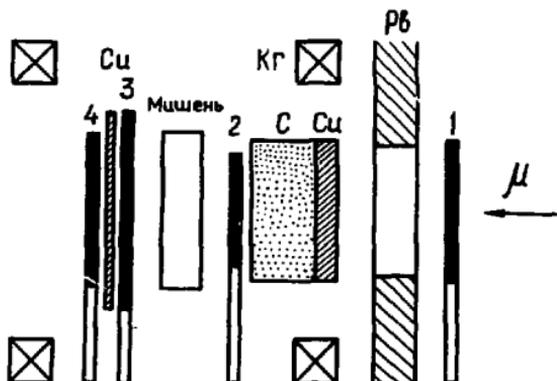
Рис. 1. Схема установки для определения остаточной поляризации мюонов в веществе.
