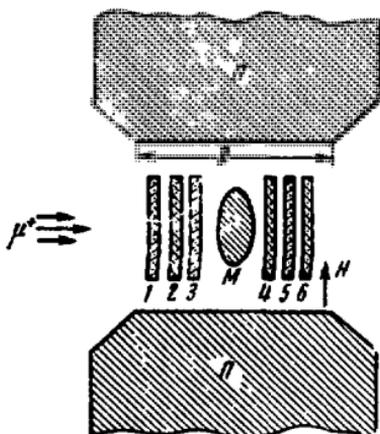
Рис.3. Схема опыта: М-мишень из ферромагнетика, П-полюса электромагнита, 1-6 сцинтилляционные счетчики.
