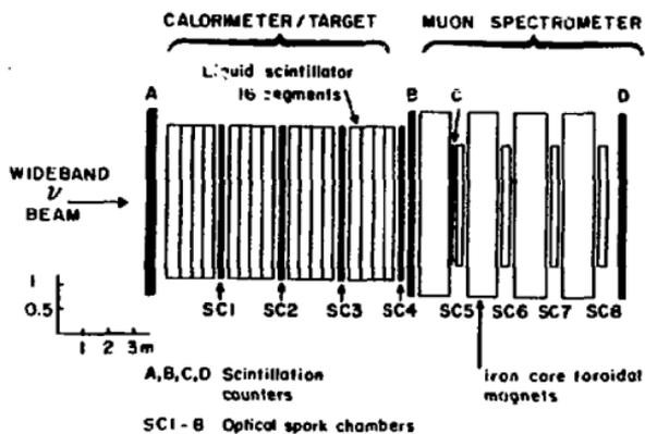
Рис.2. Схема эксперимента группы Гарвард-Пенсильвания-Висконсин в Батавии.
