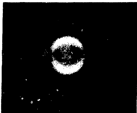
Р и с. 1. Фотография ондуляторного излучения на длине волны \lambda = 3850 \text{ \AA} . Энергия электронов E = 166 \text{ МэВ} .
