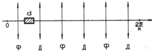
Рис.1. Структура периода магнитной системы.
