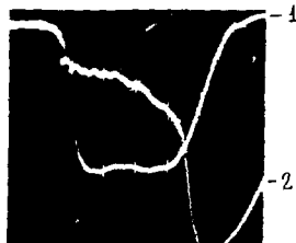
Рис. 3. Осциллограммы импульсов напряжения (1) и тока намагничивания (2) индуктора ( m_{\text{ин}} = 2 кВ/дел, m_{\text{Т}} = 50 нс/дел).
