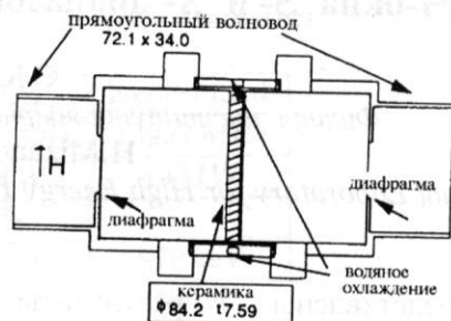
Рис. 2. Конструкция окна S диапазона.
