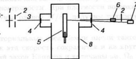
**Взрывная камера** сделана из нержавеющей стали и имеет входное и выходное окна для СИ, высоковольтный ввод для инициирования детонатора, четыре кабельных вывода для синхронизирующих электрических сигналов, выхлопной канал для вывода газов (продуктов детонации), два крана для подключения к вакуумной системе и для наполнения газами.
