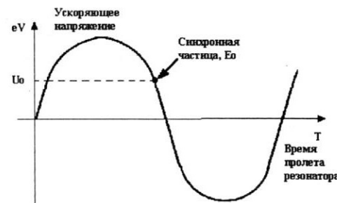
Рис.2.3.1. Ускорение частиц высокочастотным напряжением
