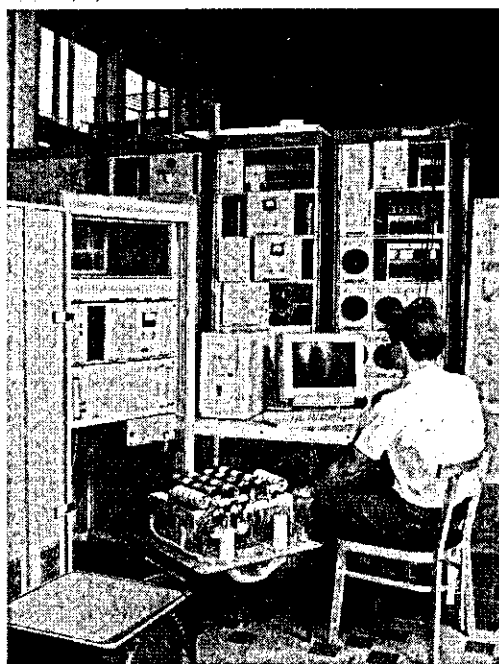
Рис. 3. Рентгеновское питающее устройство в процессе наладки.
