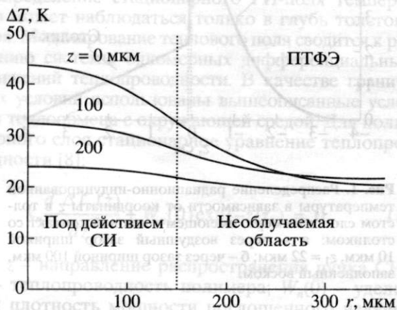
Рис. 3. Расчетное радиальное распределение радиационно-индуцированного теплового поля в области микро-роструктур цилиндрической формы в толстом полимерном слое в зависимости от глубины z . Условия облучения: E = 2 ГэВ, I = 150 мА, W(0) = 2.3 \cdot 10^8 Вт/м 3 .
