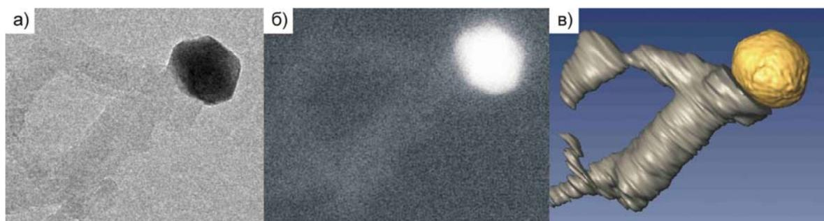
Рис. 1. (а) Изображение частицы медно-никелевого сплава с образовавшимся на ней углеродным волокном в режиме светлого поля; (б) то же в режиме Z-контраста; (в) модель поверхности томографически реконструированной частицы и углеродного волокна в ориентации, соответствующей снимкам (а) и (б).
