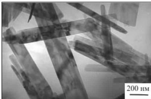
Рис.2. Нанотрубки  $VO_2(B)$ .
