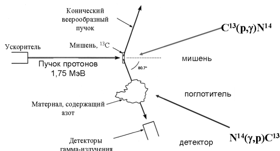
Рис. 1. Принципиальная схема эксперимента по детектированию повышенного содержания азота в веществе
