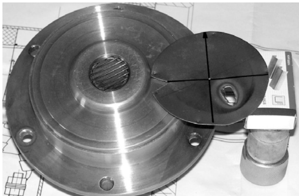
Рис.12. След пучка на фольге и катодно-сеточный узел (диаметр сетки 20 мм)
