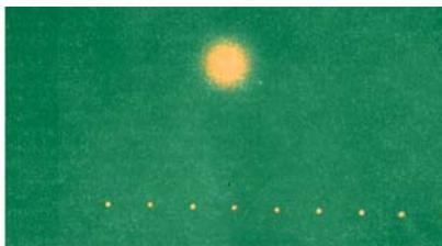
Первая в мире установка электронного охлаждения. Справа вверху показан атомарный пучок с диаметром менее 1 мм, возникающий в результате рекомбинации и прошедший расстояние 10 м до попадания на пленку. Угловой разброс пучка существенно меньше  $10^{-5}$ , а температура в сопутствующей системе составляет порядка 10 К
