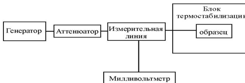
рис.1 Лабораторная установка для определения комплексной диэлектрической проницаемости с использованием блока термостабилизации.
