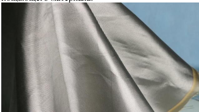
Рис.1 Вид радиопоглощающего материала на гибкой тканевой подложке
