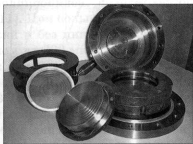
Рис. 6. Общий вид комплекта деталей вакуумированной камеры, пресс-матрица для штамповки и образец СДЛ.
