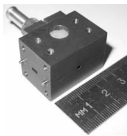
Внешний вид типичного переключателя терагерцового излучения
