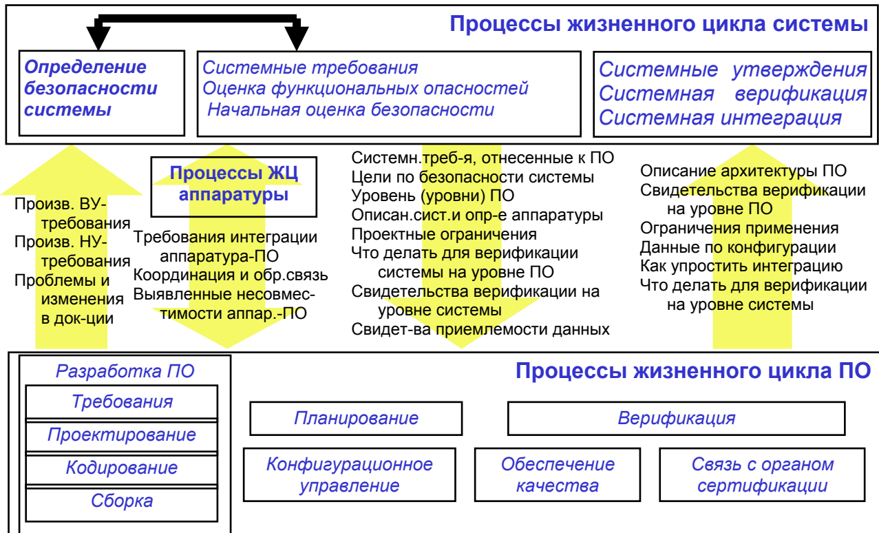
Рис. 5. Связь процессов жизненного цикла системы и ее программного обеспечения
