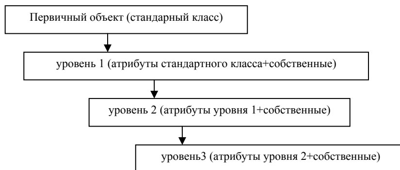
Рис. 2. Иерархическая модель объектов
