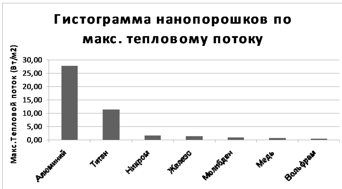
Рис. 1. Максимальный тепловой поток при горении различных нанопорошков металлов
