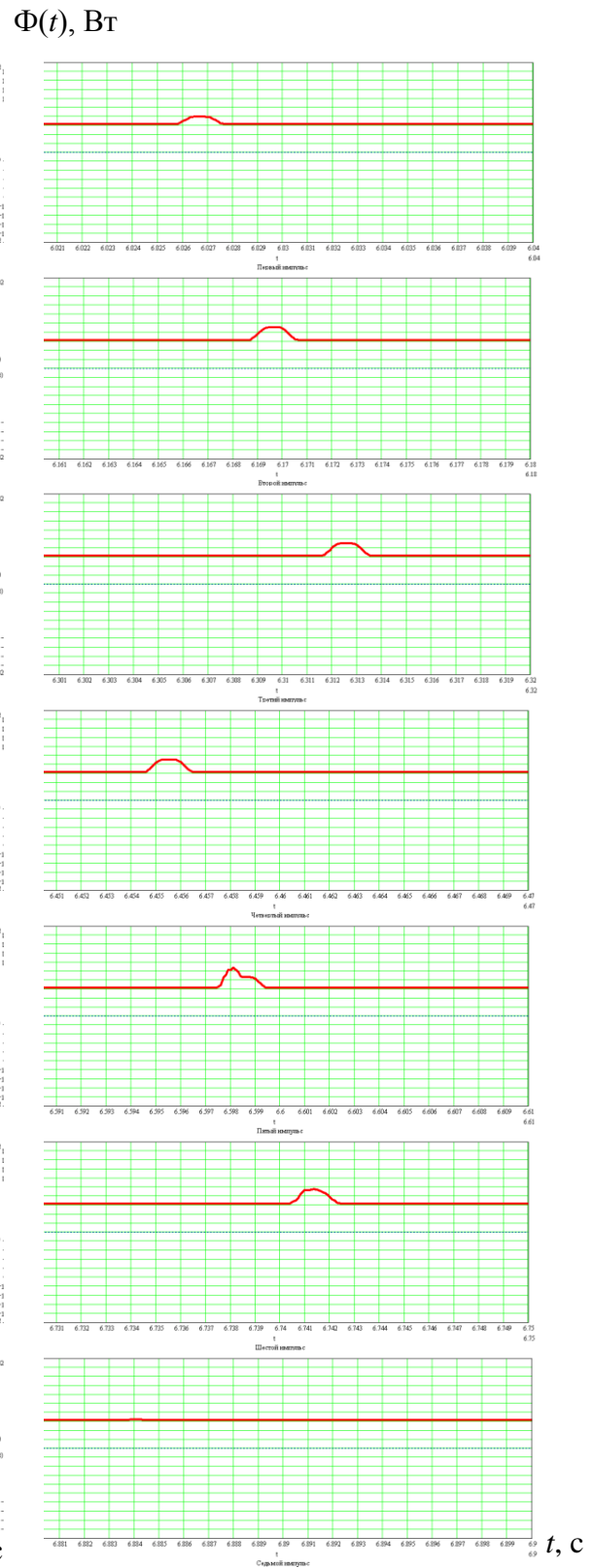
Рис. 4. Импульсы полезного сигнала от объекта при последовательном пересечении поверхности полем зрения локатора (2 вариант ориентации объекта)
