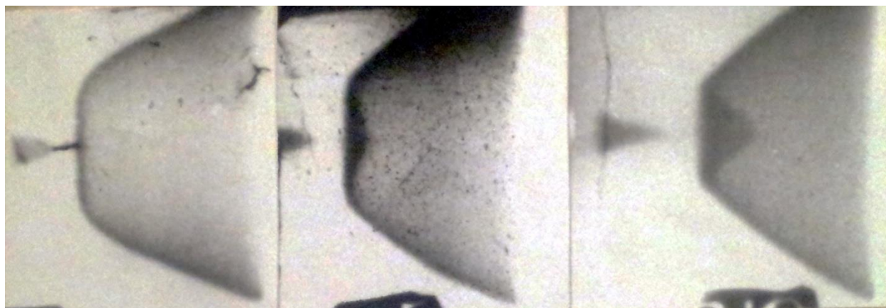
Рис. 1. Начальная стадия обжатия кумулятивной облицовки
