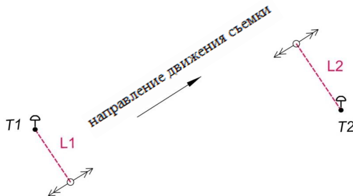
Рис. 2. Схема GPS съемки объектов ЛЭП методом перпендикуляров: T1, T2 – точки съемки; L1, L2 – длины промеров
