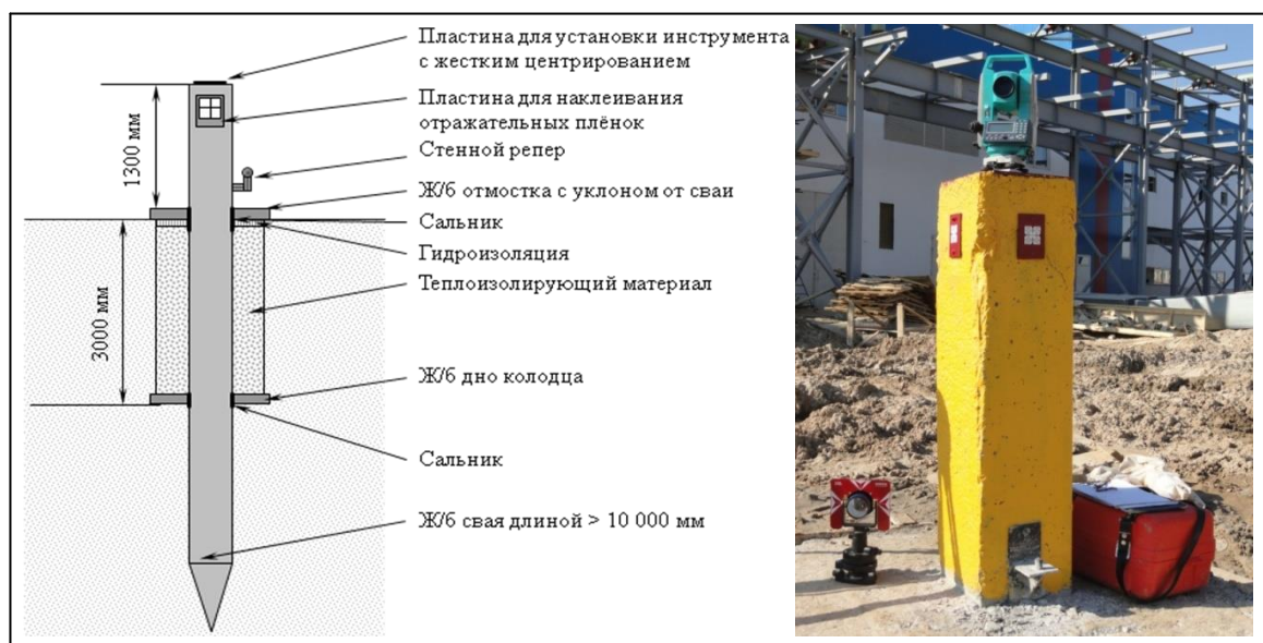
Рис. 1. Схема свайного опорного геодезического пункта (ОГП)
