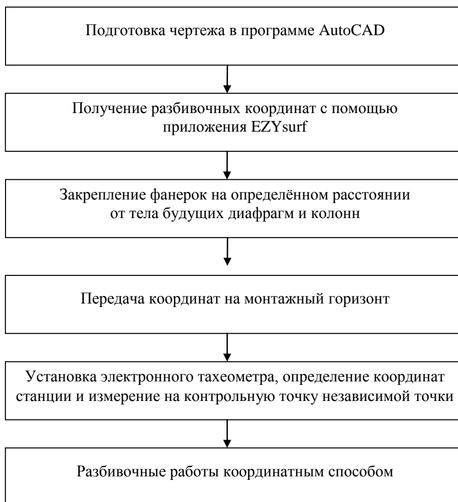
Рис. 3. Технологическая схема разбивочных работ на монтажных горизонте
