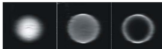
Рис. 3. Профили пучка при потенциале управляющего электрода 0, +100, +300 В и потенциале анода +500 В
