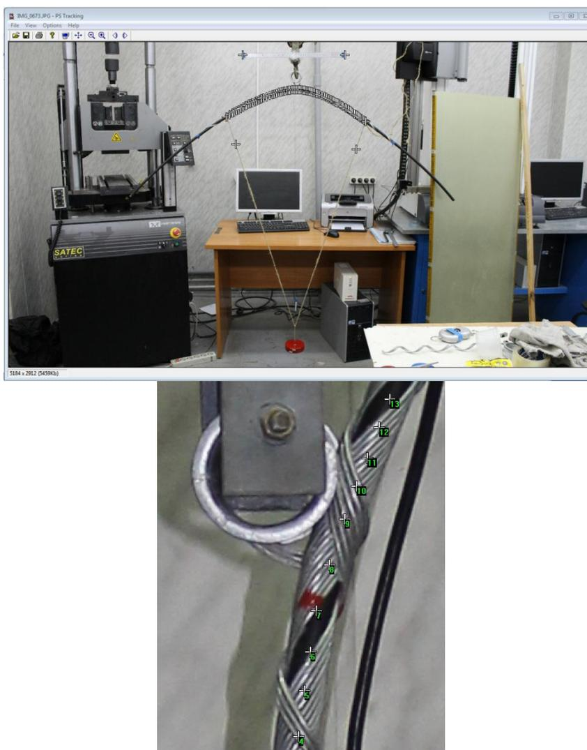
*Рис.4. Проставление меток в программе для считывания текущей координаты*
