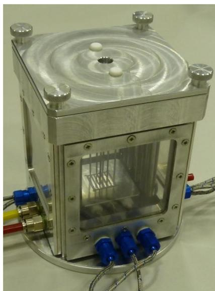
Рис. 2. Ячейка для мониторинга структуры и вольт-амперных характеристик активного слоя полимерных фотоэлементов
