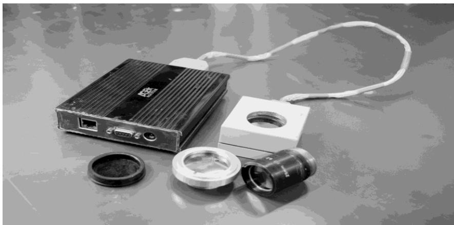
Рис.1- Состав стенда (плюс программное обеспечение) слева направо: блок обработки, МФУ, крышка-шторка для нормирования чувствительности, однолинзовый объектив, двухлинзовый объектив
