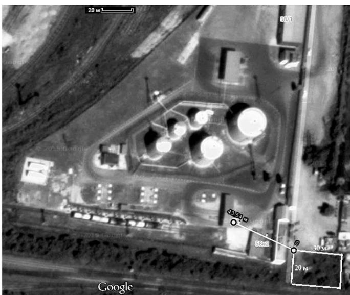
*Рис.2. План нефтебазы и предлагаемое расположение участка для сварочных работ.*
