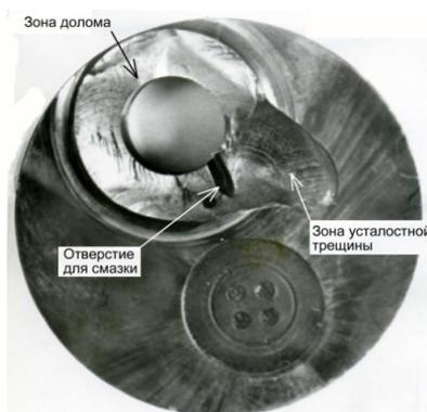
*Двигатель 3Дб - разрушение в первую навигацию после ремонта*
