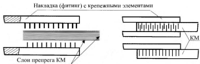
Рис. 2. Конструктивно-технологическое решение соединения с поперечными заформованными крепежными микроэлементами [4]
