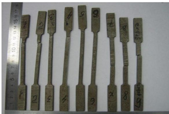
Рис. 4. Удлинение образцов после нагружения
