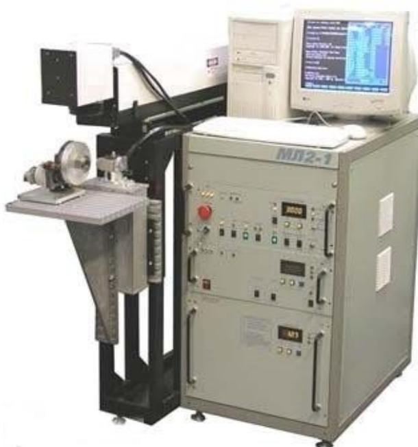
Рис.3. Установка для лазерной маркировки и гравировки МЛ2-1
