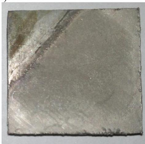
Рис.3. Покрытие, полученное при плотности тока  $D_k = 8 \text{ А/дм}^2$
