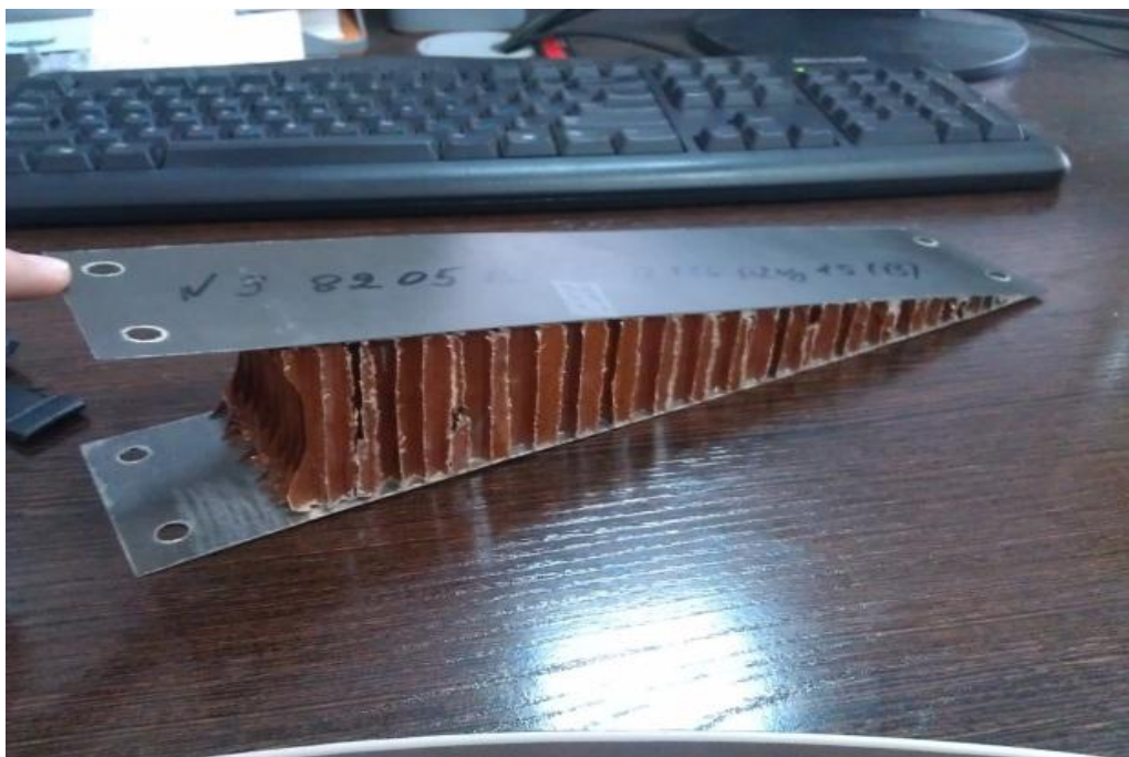
Рис. 3. Фрагмент хвостовой секции лопасти несущего винта вертолета Ка-32
