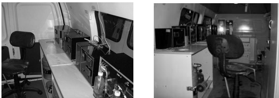
Рис. 1. Салон мобильной лаборатории «КЛАН-1», укомплектованный анализаторами СИМ
