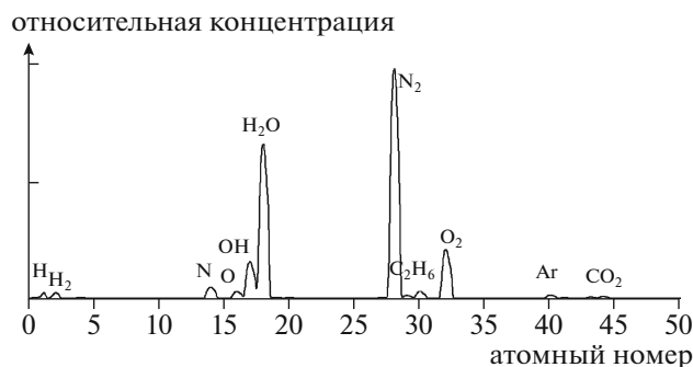
Рис. 4. Масс-спектр остаточного вакуума установки ГОЛ-3 (относительная концентрация).
