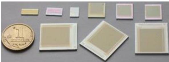
Рис.1. Типовые кристаллы мультиплексоров, разработанные в ИФП СО РАН для создания ИК ФП.
