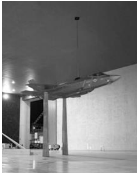
Рис. 1. Установка для натурных измерений ЭПР самолета F-35
