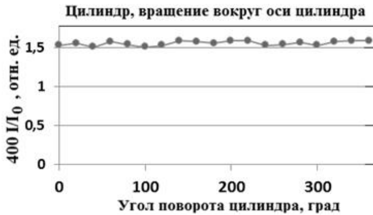
Рис. 9. Угловая зависимость относительной интенсивности ТГц-излучения при обратном рассеянии от боковой поверхности вращающегося цилиндра
