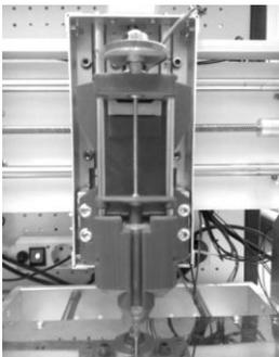
Рис. 1 – Печатающая головка
