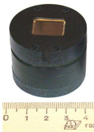
Рис. 2. Тепловизионный модуль МТП834М «Пика – М»
