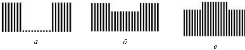
Рис. 1. Распределение плотности наночастиц в различных типах дефектов: микрополости (а), желобкообразном дефекте (б), полосковом дефекте (в)
