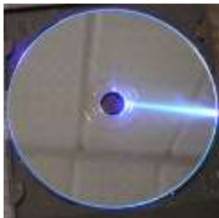
Рис. 2. Образец трехслойного оптического диска архивного типа
