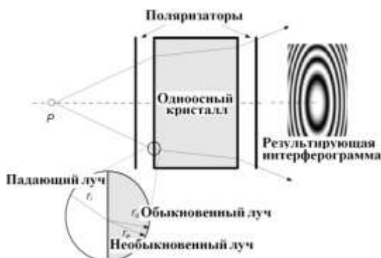
Рис. 1. Принцип работы коноскопического узла
