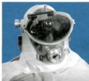
Рис. 2. ТВ монокуляр в рабочем положении на шлеме водолаза.
