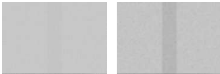
Рис. 1. Модель рентгеновского контраста стенки бериллиевой мишени в виде полосы интенсивностью 1% и наложенным на неё 5% Гауссовым шумом (слева) и результат обработки изображения после фильтрации шумов, динамический диапазон изменён для лучшей визуализации
