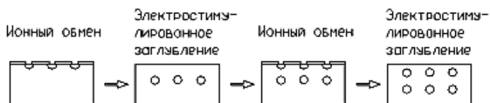
Рис. 1. Схема технологии формирования двухслойных интегрально-оптических схем
