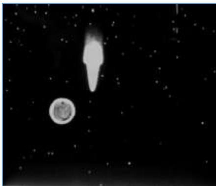
Рис. 1. Обычное изображение: горячий паяльник и пятно от лазерных импульсов \lambda = 1.54 мкм с выхода оптоволокну, t_{\text{и}} = 50 нс
