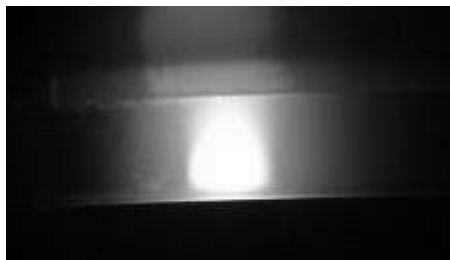
Рис. 1. Люминесценция торца волновода, записанного УФ-излучением, длина волны возбуждения 405 нм
