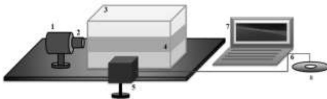
Рис. 1. Экспериментальная установка для регистрации каустик СЛИ в диффузионном слое жидкости: 1 - лазер, 2 - оптическая система, 3 - кювета, 4 - диффузионный слой, 5 - цифровая фотокамера, 6 - персональный компьютер, 7 - 2D рефрактограмма, 8 - программное обеспечение
