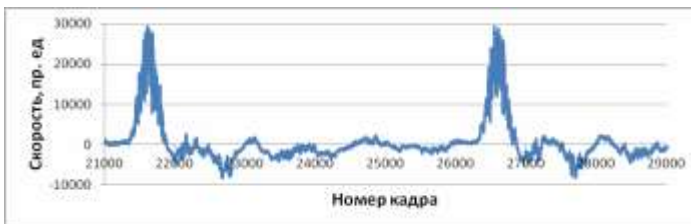
Рис. 1. Сигнал ПВ, зарегистрированный с расстояния 13 метров с запястья руки субъекта
