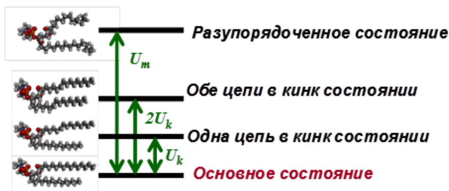
Рис. 1. Иллюстрация основного, кинк и разупорядоченного состояний углеводородной цепи в рамках модели
