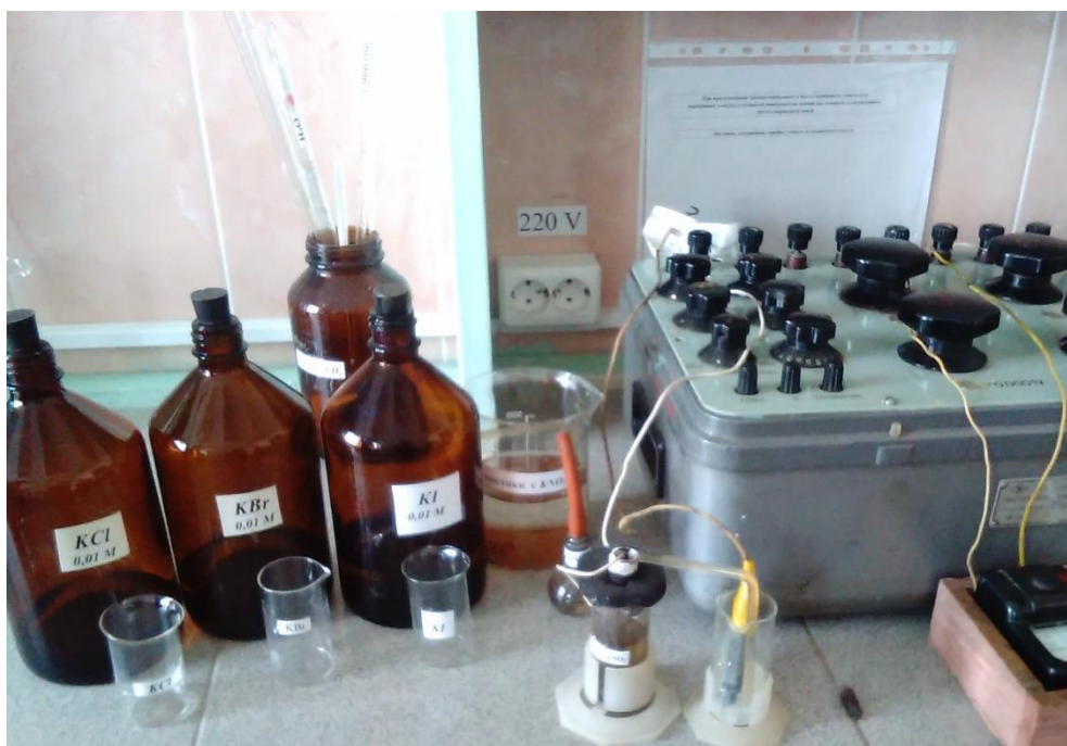
Рис. 1. Измерение ЭДС цепи с использованием потенциометра
