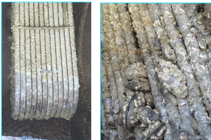
Рис. 1. Биологическое загрязнение внешней поверхности трубок охладителя
