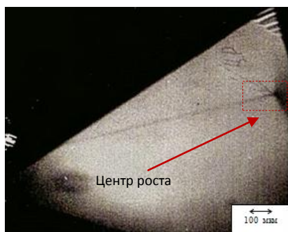
Рис. 1. Центр роста на грани (101) кристалла \alpha -LiIO 3
