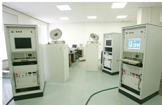
Рис. 1. Плазмохимические СВЧ-реакторы ARDIS-100 производства ООО «Оптосистемы»
