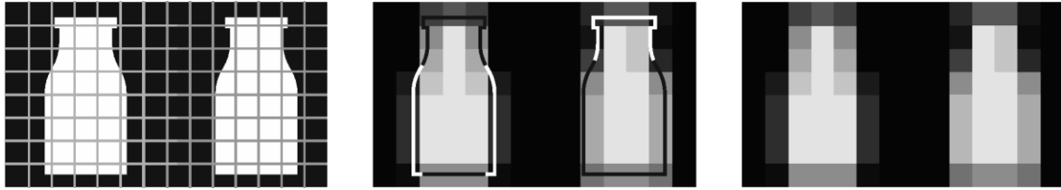
рис. 1. Изменение формы изображения малоразмерного объекта в зависимости от его расположения на матрице фотоприемника
