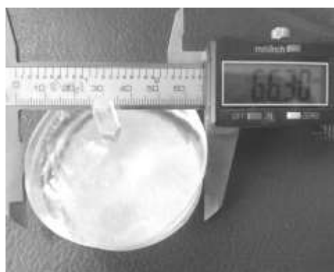
Рис. 1. Фотография кристалла \beta - \text{BaB}_2\text{O}_4 , выращенного в системе 0.7 \text{ BaB}_2\text{O}_4 - 0.3 (0.4 \text{ NaF} - 0.6 \text{ LiF}) .
