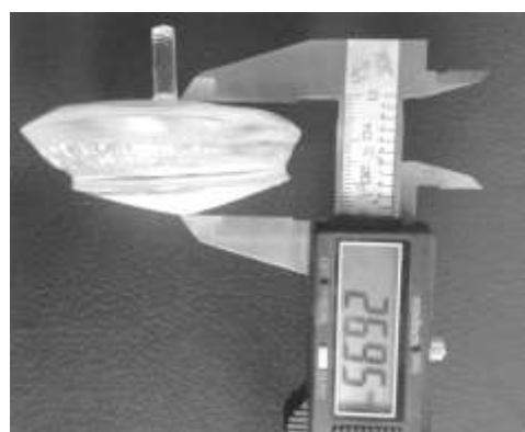
Рис. 1. Фотография кристалла \beta - \text{BaB}_2\text{O}_4 , выращенного в системе 0.7 \text{ BaB}_2\text{O}_4 - 0.3 (0.4 \text{ NaF} - 0.6 \text{ LiF}) .
