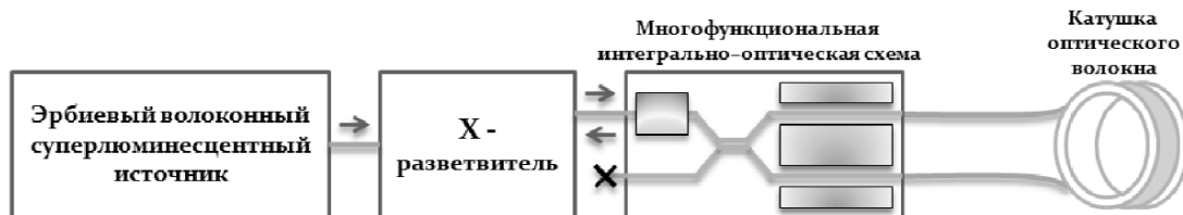
Рис. 1. Оптическая часть блок-схемы интерференционного ВОГ [4]
