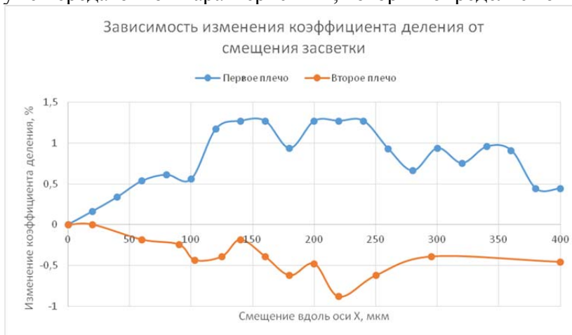
Рис. 5. Зависимость изменения коэффициента деления от смещения области засветки вдоль оси X в различных участках Y-разветвителя
