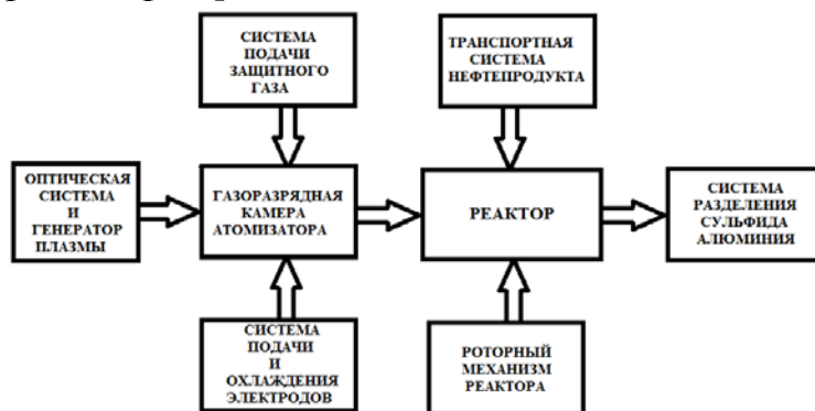
Рисунок 1 – Структурная схема десульфуризатора нефтепродуктов
