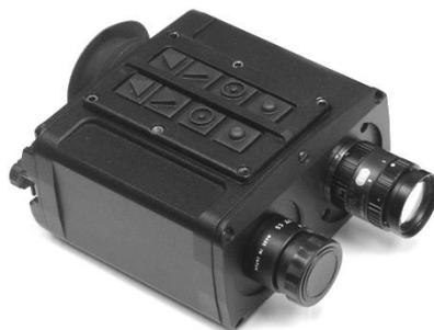
*рис. 1. Внешний вид прототипа активно-импульсного прибора.*
