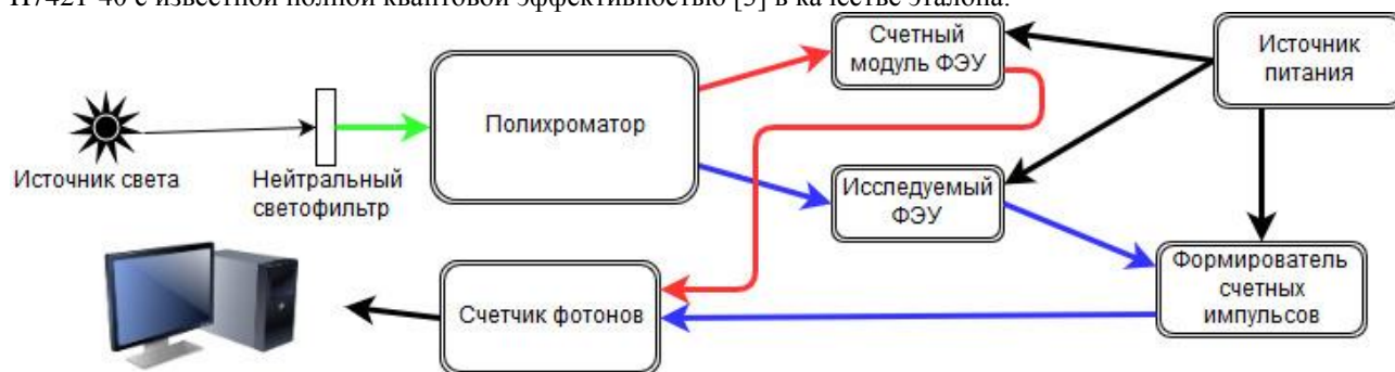
рис. 1. Блок-схема для определения полной квантовой эффективности системы счёта фотонов
