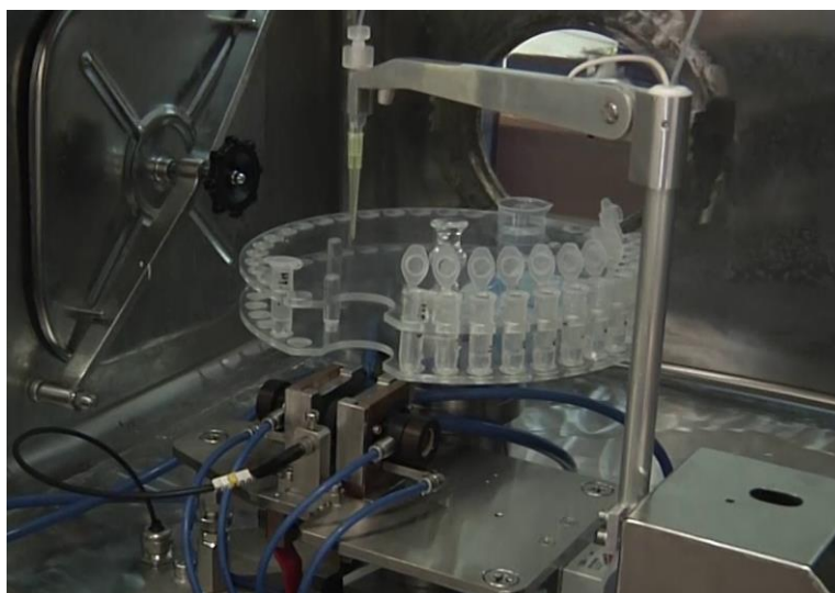
Рис. 8. Автоматический дозатор с электротермическим атомизатором внутри защитного химического бокса
