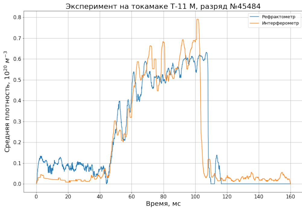
Рис. 2. Разряд № 45484. Средняя плотность, измеренная штатным КМП и МИР
