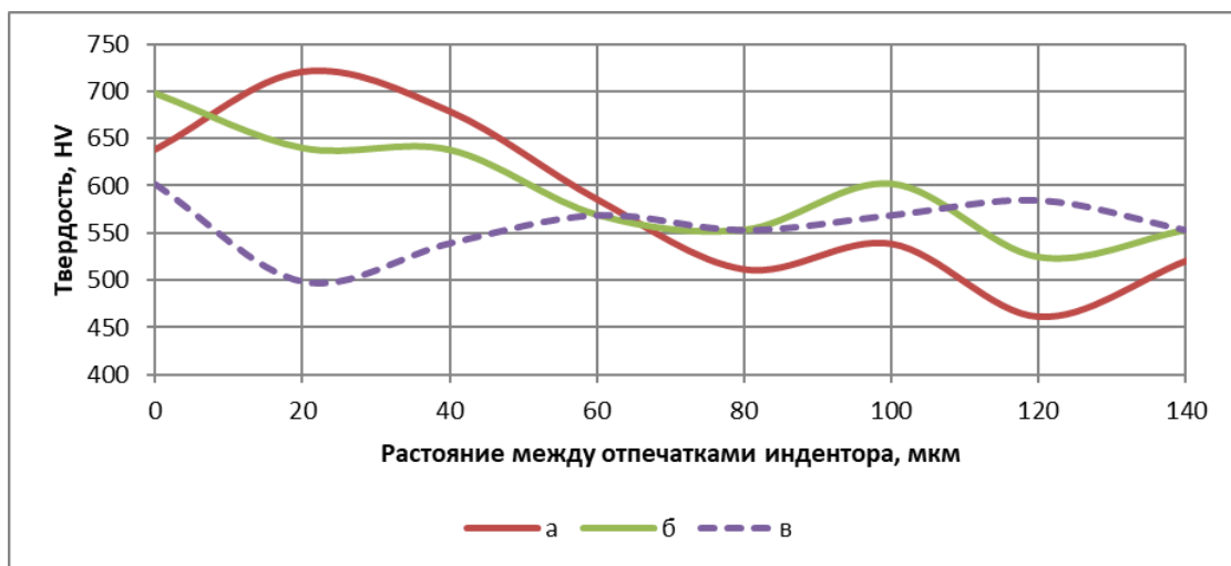
Рис. 2. График твердости в трех различных областях (а – зона термического воздействия, б – зона деформационных полос, в – исходный материал)
