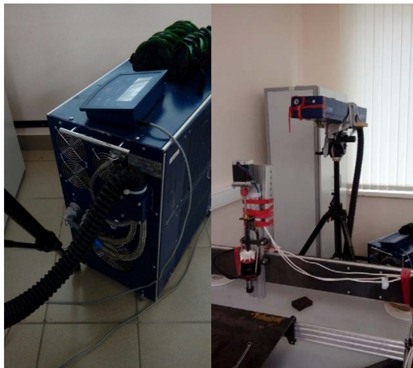
Рис. 1. Лазерный комплекс для генерации импульсов широкополосного лазерного излучения LQ 529 В (Солар Лазер Систем)
