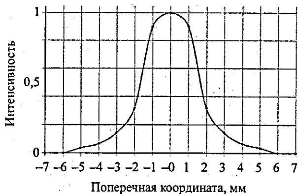
Рис. 10. Нормированное распределение квантов тормозного излучения, вышедших с поверхности выпускной фольги
