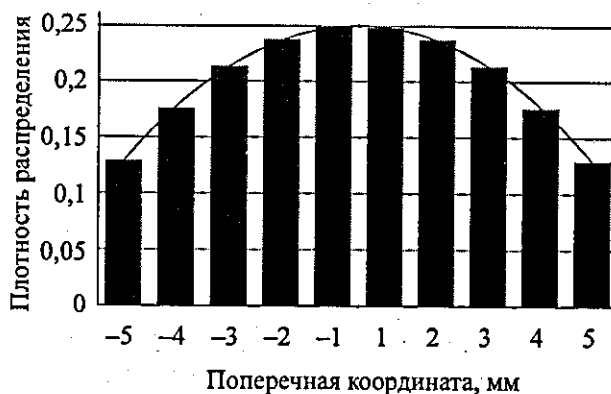
Рис. 11. Профиль пучка электронов, падающего на выходную фольгу
