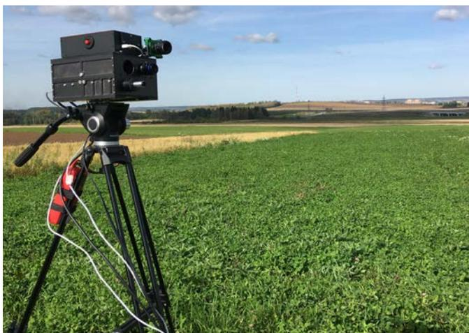
**Рис. 1.** Полевая спектральная изображающая система, дополненная спектрометром Avesta ASP-150C и мультиспектральной камерой Silios CMS-V.
