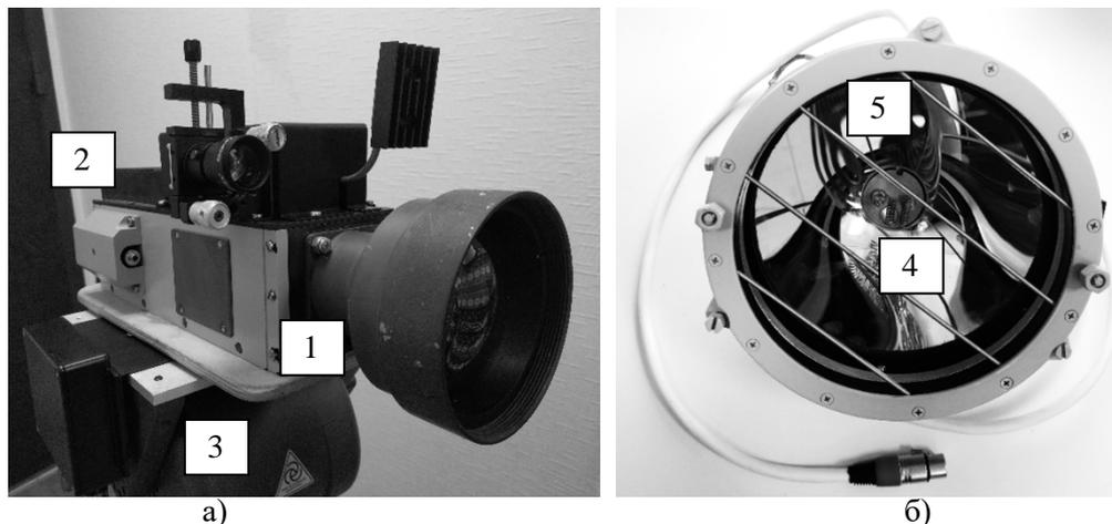
**Рис. 1.** Внешний вид основных модулей системы мониторинга среды: а) блок опто-механический: 1 – фурье-спектрометр; 2 – телевизионный визир; 3 – опорно-поворотное устройство; б) блок источника излучения: 4 – нихромовая спираль; 5 – параболический рефлектор.
