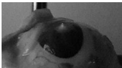
Рис. 1. Фото лазерных меток однолучевого метода триангуляции на роговице свинога глаза ex vivo
