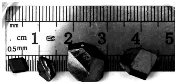
Рис. 1. Фотография синтезированных монокристаллов \text{CH}_3\text{NH}_3\text{PbI}_3
