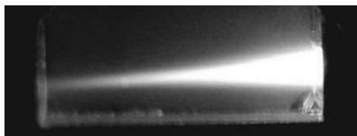
Рис. 1. Фотография люминесценции образца после облучения He-Cd лазером и термообработки при температуре ниже T_g , длина волны возбуждения 405 нм
