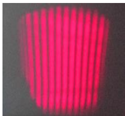
Рис. 2. Дифрагированная интерференционная картина \lambda=633\text{ нм}
