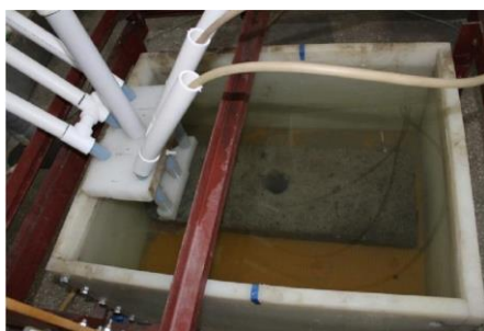
рис. 1. Вид образца с установленной накладной электродной системой
