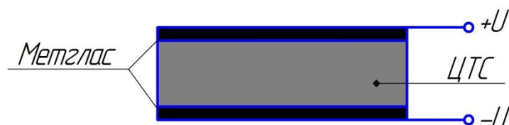
рис. 2 - Магнитоэлектрическая сруктура датчика.
