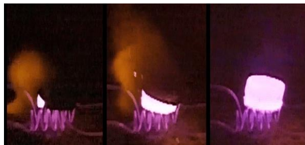
рис.2. Самораспространяющийся высокотемпературный синтез
