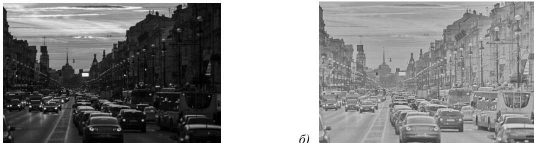
рис.2. Исходное изображение (а) и результат обработки рассматриваемым методом нелинейного контрастирования (б)
