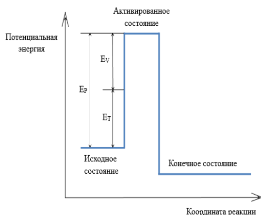
Рисунок 1 – Схема изменения потенциальной энергии системы атомов частицы и основы
