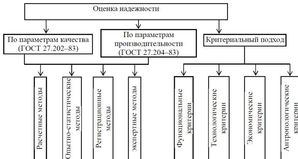
Рисунок 1 – Методы оценки надежности технических объектов, технических систем и технологических систем
